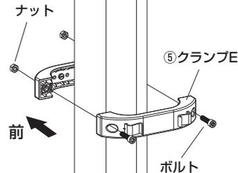
③クランプEに下棚HをボルトLで取付けます。
