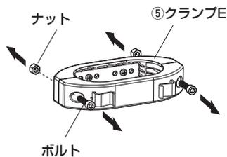
②メインフレームDにクランプEを任意の高さに取付けます。
