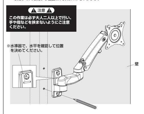
② ドリルを使い壁に印をつけた2カ所に直径4mm 深さ約60mmの下穴をあけます。
