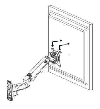
③ ボルトでディスプレイを固定します。 ※ボルトは4本ともしっかり締めてください。
