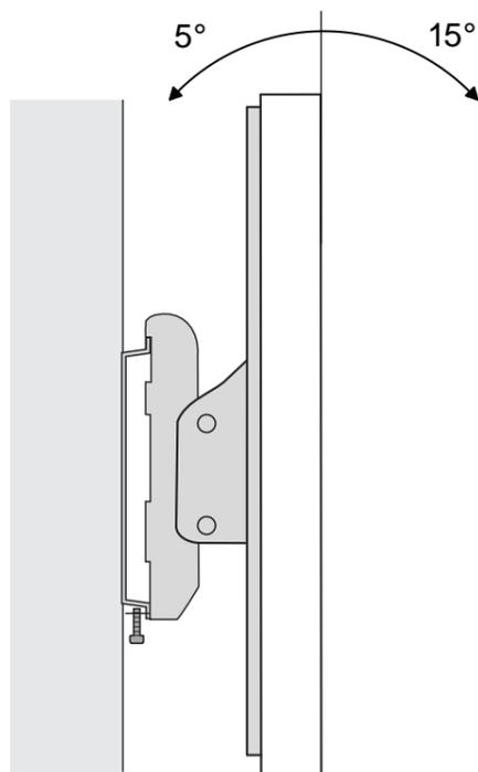
一旦壁面から取り外してディスプレイ用ブラケットのナットを付属のスパナを使い緩めます。
