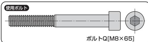
※レッグフレーム左と右とセンターが水平になるように調節しながらボルトを締めてください。
