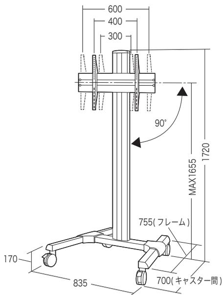
総耐荷重 65kg(40kg以下のテレビを取付け可能)
