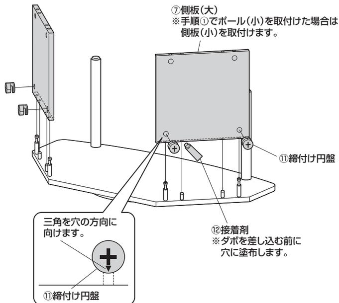
②締付け円盤を回して固定します。
