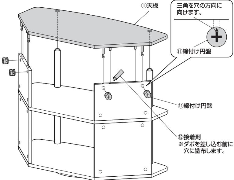
②締付け円盤を回して固定します。
