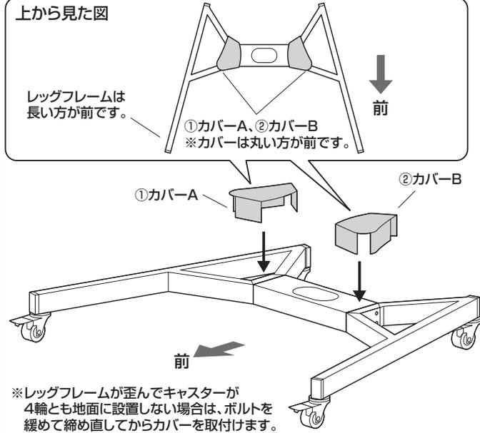
※レッグフレームが歪んでキャスターが4輪とも地面に設置しない場合は、ボルトを緩めて締め直してからカバーを取付けます。
