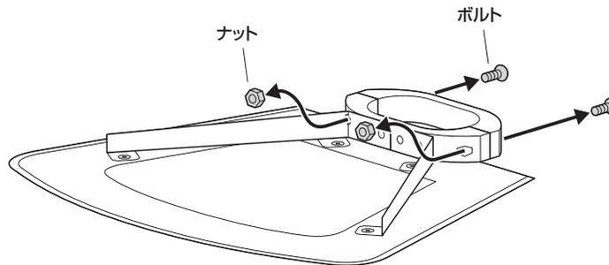
② 支柱Hに棚板用ブラケットDを取付けます。
