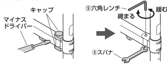
六角レンチでボルトをゆるめて角度を変えます。変更後はボルトをしっかりと締めてください。
