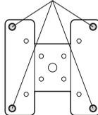
※ボルトが最後まで締まらない、またボルトが少ししか回っていないなど、ボルトが合わない場合は、強度に十分ご注意ください。市販の適切なボルトをご用意ください。
