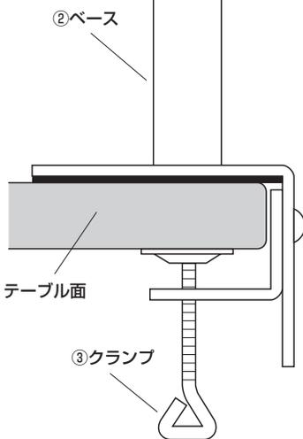
※テーブルの厚さによってクランプを取り付ける穴を変えてください。
