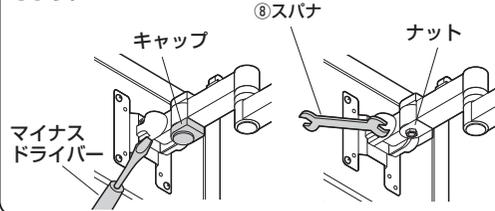
上下のキャップをはずし、六角レンチとスパナでボルトを締め付けて調節します。
