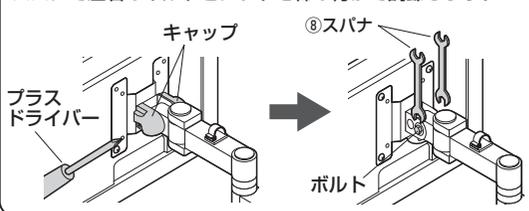
キャップをはずし、スパナでナットを締め付けて調節します。
