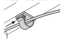
①キャップを外して、ケーブルをベースの中を通します。
